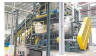
これをきっかけに、現地の電力会社が廃棄物を石炭の代替燃料などに変換する(株)伸光テクノスの加水分解装置(写真左)を導入。この装置で作られた燃料は、火力発電に活用されています。
